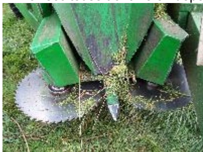
Le système de coupe : deux disques tournant vers l'extérieur
