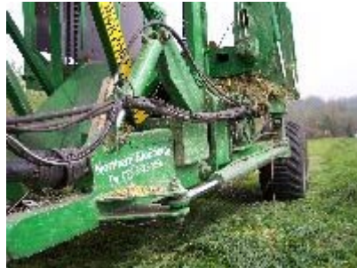
Réglage du déport de la remorque
