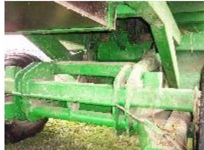
Réglage de la hauteur de caisse
